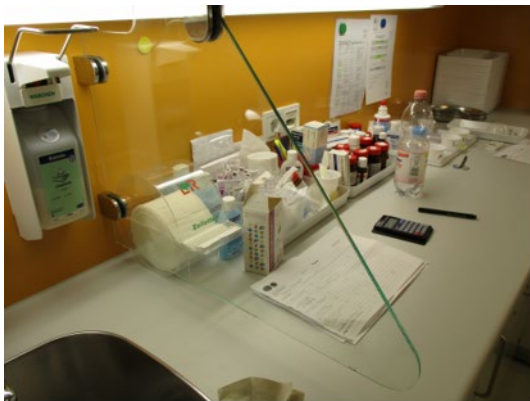
Abbildung 17: Beispiel für die Anbringung eines Spritzschutzes
